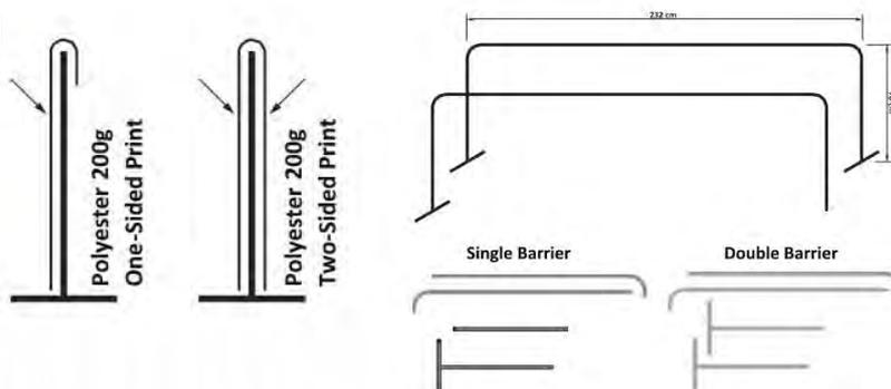
**Begrenzungs-Banner** sind ein leichtes, tragbares Ausstellungssystem, mit dem Sie den gewünschten Raum schnell umzäunen können. Die Struktur der Werbezüge besteht aus Stahlrohren mit einem Durchmesser von 18 mm, pulverbeschichtet in mattschwarz. Die Größe einer Tischtennishürde beträgt nach dem Auseinanderfalten und Zusammenbau **230x70 cm**. Das gesamte Produkt ist in einem schwarzen Cordura-Beutel verpackt.
